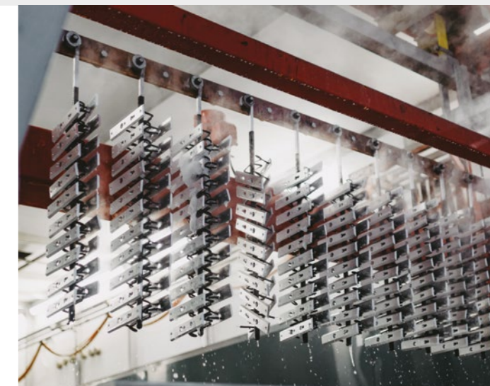
fot. barwienie metodą anodowania powoduje większą trwałość produktu; AXA©.
